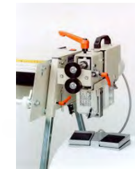
Zuschneidevorrichtung mit Sickenmaschine
