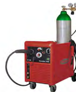
MAG - poste de soudage CO2
